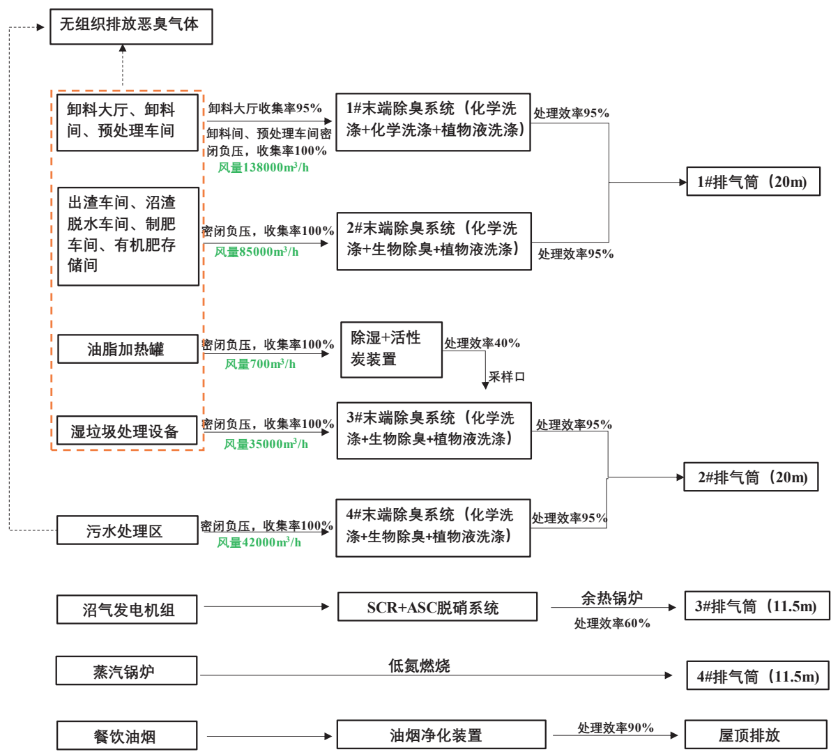
图 3.5-1 本项目主要废气收集及排放形式
