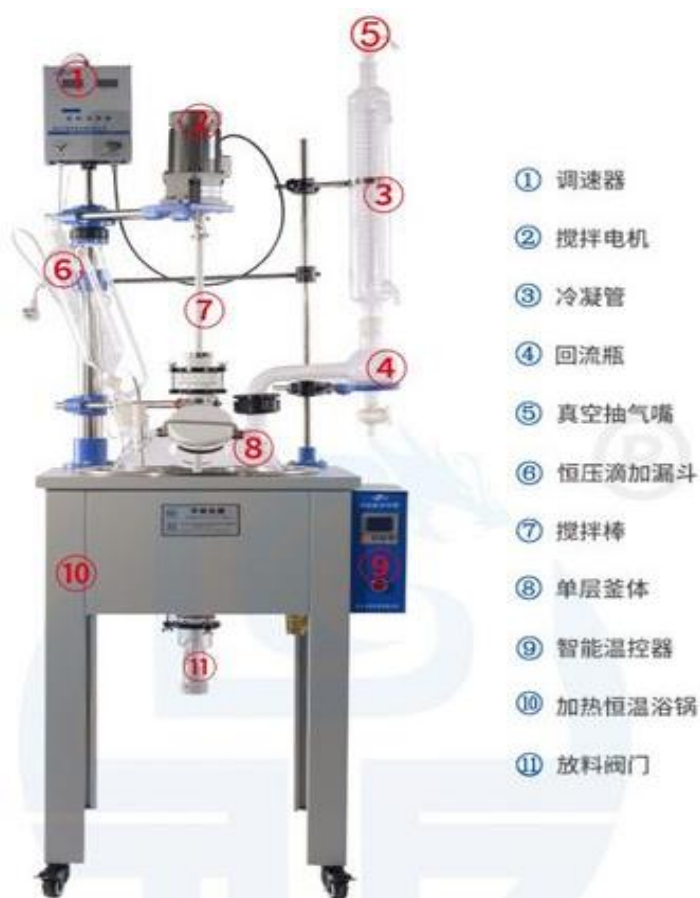
图 3 玻璃反应釜结构示意图
