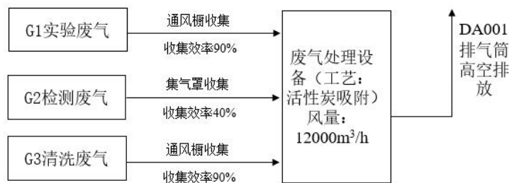
图 4-1 项目实验废气收集处理系统
