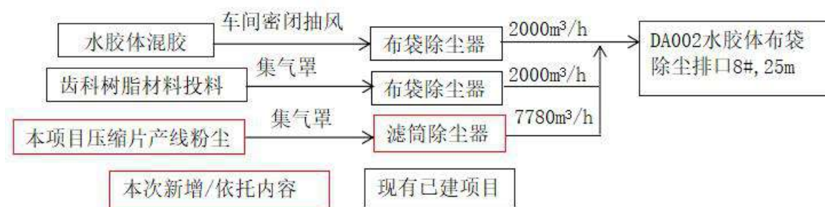
图 2-3 本项目废气收集处理系统图
