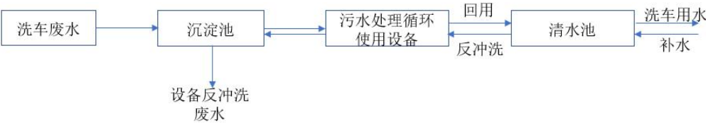
图 4-1 洗车废水处理工艺流程
