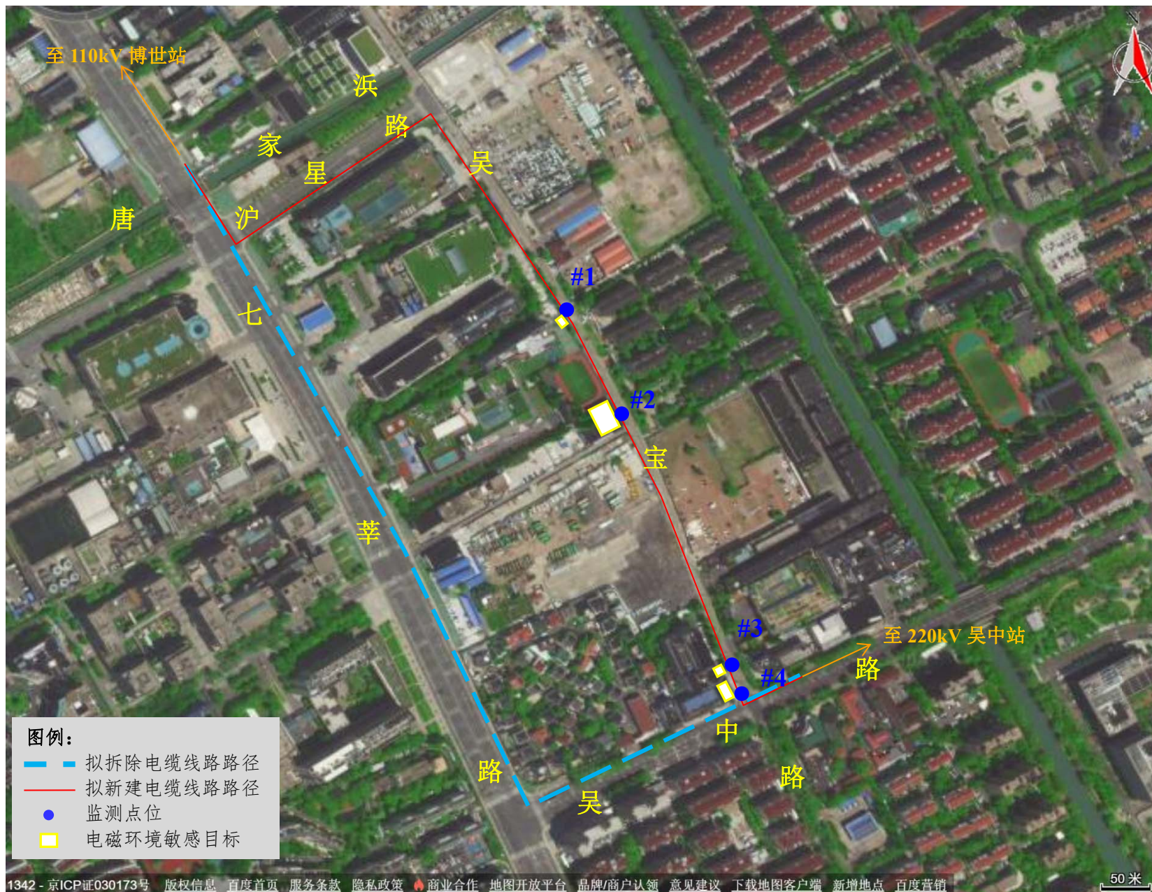
附图3 本工程新建电缆路径、拆除电缆路径、环境敏感目标、本底监测点位布置图
