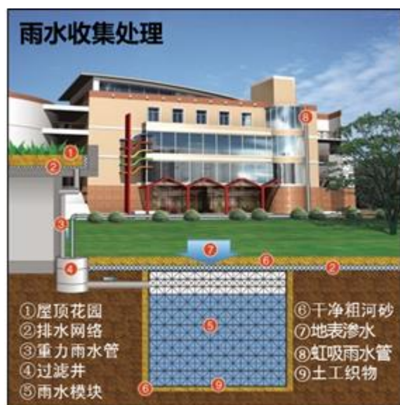
图 4-3 与绿地相结合的雨水收集系统示意图
