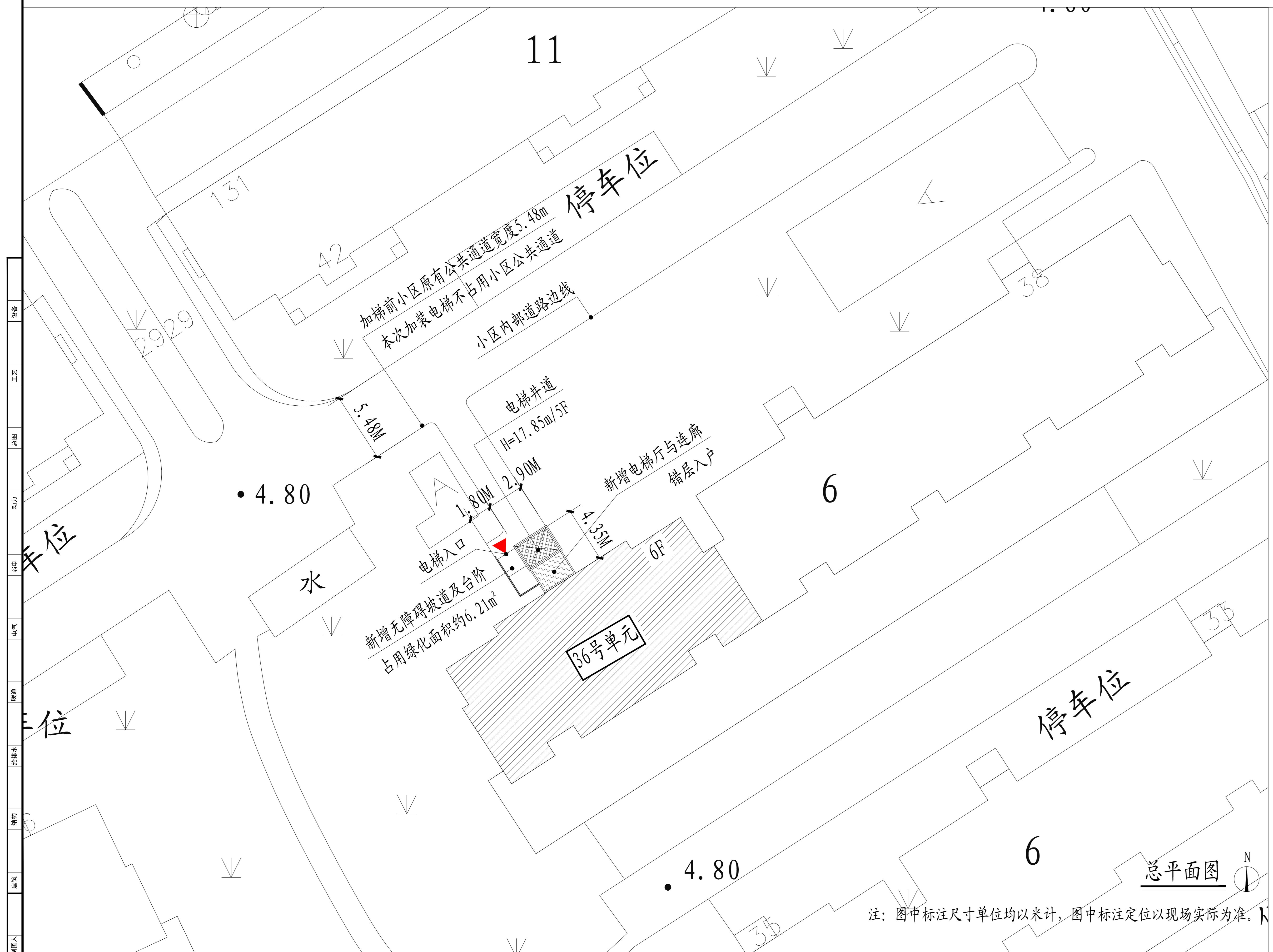
注：图中尺寸单位均以米计，图中标注定位以现场实际为准。
