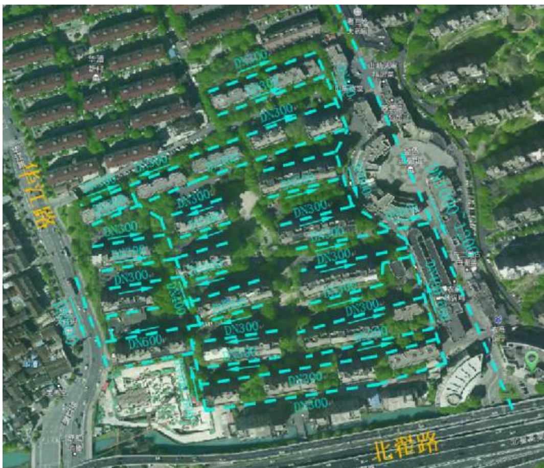
图2.4-3 积水点1现状雨水管道示意图
