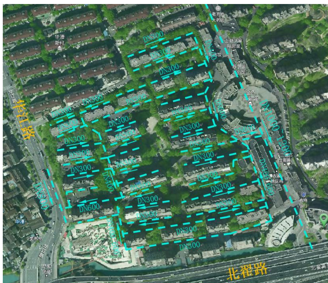
图2.4-3 积水点1现状雨水管道示意图
